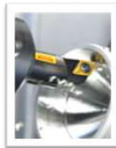
Foto 2 Mecanizado Interior del torneado 20
