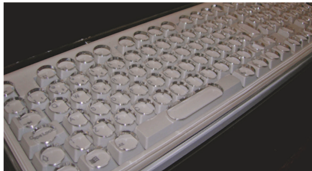
Foto 13 - Mostra um teclado com colmeia para uso do aluno com dificuldades motoras.
