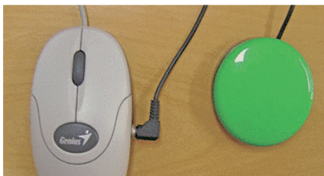
Foto 14 - Mostra um mouse com o acionador de pressão conectado.
