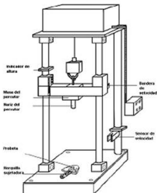
**Figura 1. Ejemplo de equipo para prueba de impacto**
