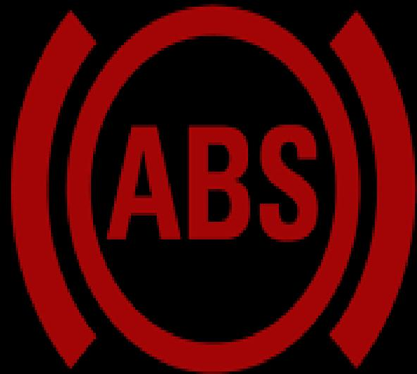
El sistema frenos antibloqueo (**ABS**) es un sistema de frenado que evita que las ruedas se bloqueen y patinen al frenar, con lo que el vehículo no solamente decelera de manera óptima, sino que permanece estable y direccionable durante la frenada (podemos girar mientras frenamos).
