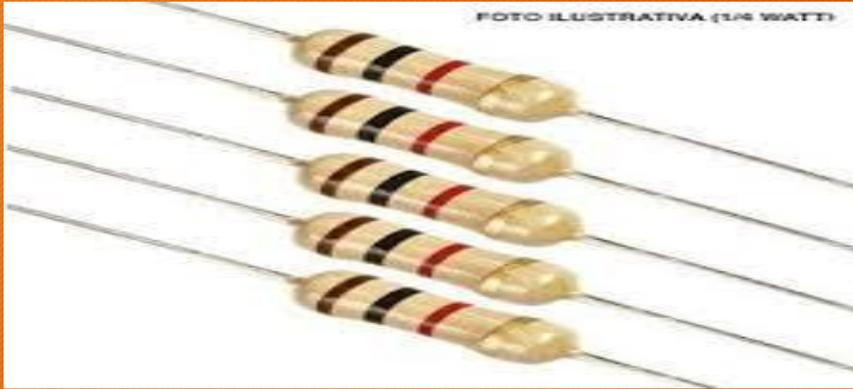
c- Dispositivo que limitan y regulan la corriente eléctrica en un circuito
