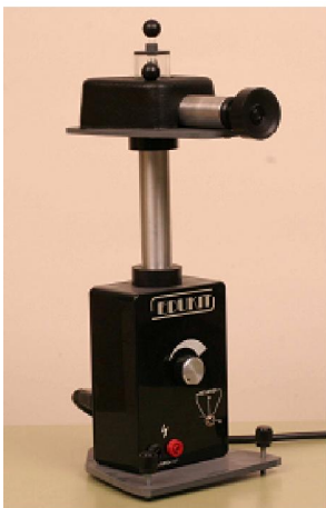
Fig. 4 Aparato actual para la realización del experimento de Milikan de la gota de aceite. En 1906 intentó medir la carga del electrón pulverizando gotitas de aceite que electrizaba y de las que seguía su trayectoria con el visor dentro de un campo eléctrico. Encontró que cualquier carga era un múltiplo entero de un valor mínimo, que era la carga elemental, es decir la del electrón.
