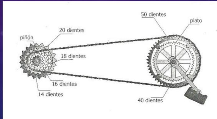
Una máquina compuesta es un dispositivo mecánico formado a partir de un conjunto de máquinas simples conectadas en serie, de forma que la fuerza resultante de una proporciona la fuerza aplicada en la siguiente.
