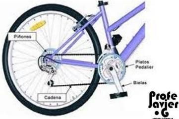
En una bicicleta se combinan una gran cantidad de operadores mecánicos cuyo propósito final es permitir el desplazamiento de la máquina a diferentes velocidades.
